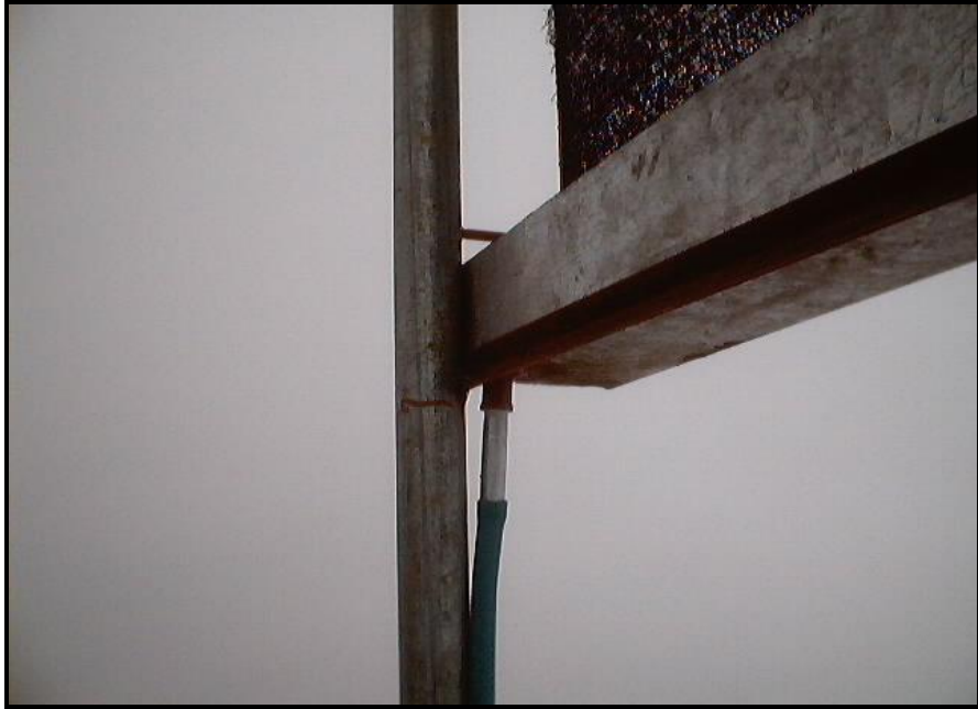
صوره توضح مجرى تجميع قطرات مياه الضباب والانبويه الخارجة منها إلى وعاء التجميع أو التخزين
